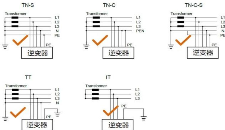
图 2.2 光伏并网逆变器支持的电网形式
