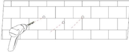
**步骤3:** 固定挂板。清理孔位，将膨胀螺栓用橡胶锤打入孔中，使用扳手拧紧螺母固定螺栓尾部后，再取下螺母、弹垫和平垫，然后将壁挂板固定与墙面上锁紧，紧固力矩 13N·m。
