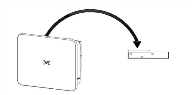
**步骤 4:** 机箱左侧孔与壁挂件用使一颗 M4×12 的螺钉固定逆变器，紧固力矩 2.5N·m。
