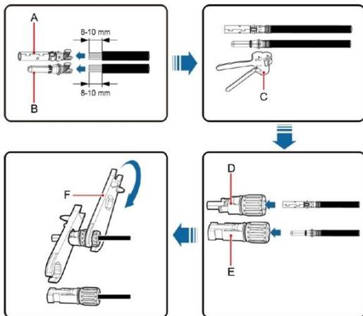
图 5.2 MC4 直流连接器与光伏组串的连接
