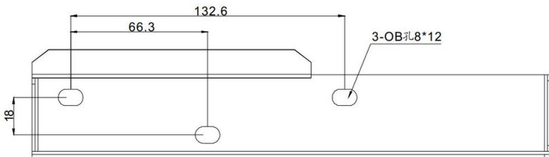
图 4.7 安装挂板尺寸图
