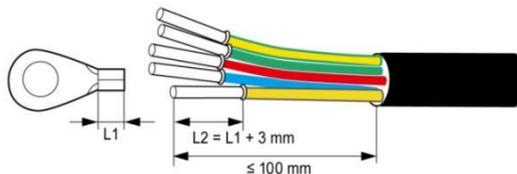
图 5.6 压接电缆端子
