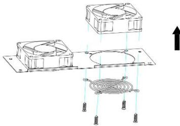
**步骤 5:** 按相反的顺序重新将风扇托盘装回逆变器，重启逆变器。
