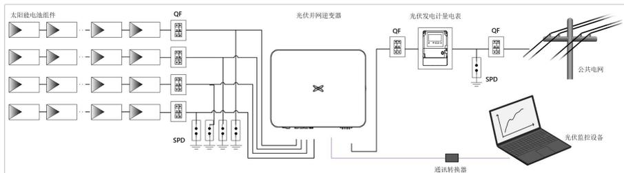
图 5.1 光伏并网系统连接示意图
