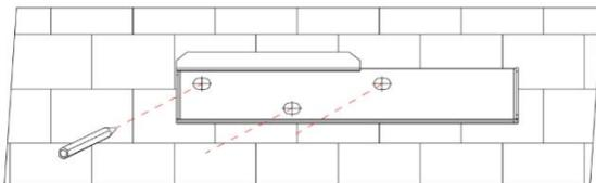
**步骤2:** 使用冲击钻打孔并安装膨胀螺栓。用户需自行准备膨胀螺栓，推荐使用M6×50不锈钢压爆膨胀螺栓。
