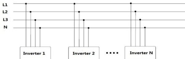
使用多台逆变器连接中压变压器的低压侧，高压侧直接连接中压电网，如果逆变器的总容量大于 1MVA, 请联系我们的售后服务人员。同时变压器需满足逆变器输出总的功率要求，且有中性点或者外接的中性导体。
